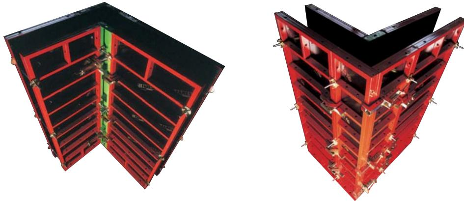
**ANGOLI:** l'elemento jolly 300x30 consente di realizzare l'angolo interno da 90°; l'angolo esterno di 90° si ottiene con la combinazione di pannelli ed eventuali compensi. In questo modo si può realizzare qualsiasi spessore di parete. Per angoli inferiori o superiori di 90° si usano due cerniere, una interna e l'altra esterna.
